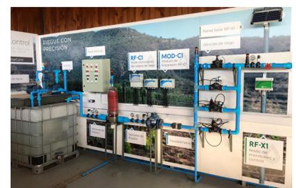
Módulo de capacitación hidráulica y telemetría agrícola.
